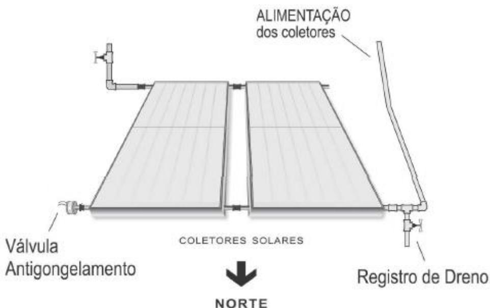
Figura 8 - Instalação válvula anti-congelamento no coletor
